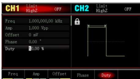
Рис. 31 Настройка значения коэффициента заполнения
