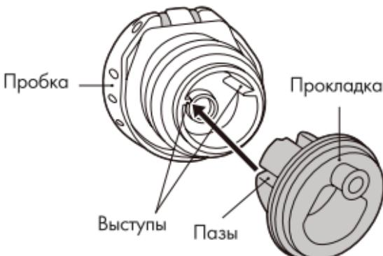
Для установки вымытой и просушенной прокладки на нижнюю часть пробки совместите пазы выступающей части прокладки с выступами на внутренней части корпуса пробки (см. рисунок). Равномерно надавите пальцем по всей окружности прокладки для плотного прилегания к основанию пробки.
