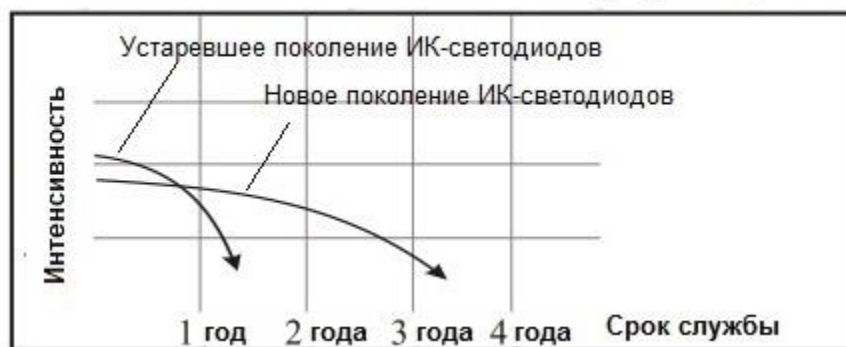
График зависимости интенсивности свечения ИК-светодиодов от срока эксплуатации
