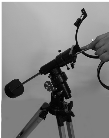
5. С помощью шестигранного ключа установите кольца трубы телескопа.
