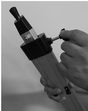
1. Зафиксируйте ногу штатива болтом
