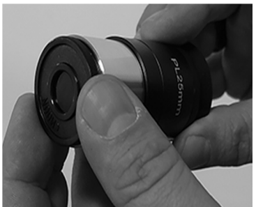
11. В случае необходимости вкрутите светофильтр в юбку окуляра
