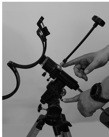
6. Снимите резиновые колпачки и установите рукоятки тонких движений.
