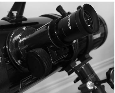
12. Установите окуляр в фокусирующий узел телескопа.
