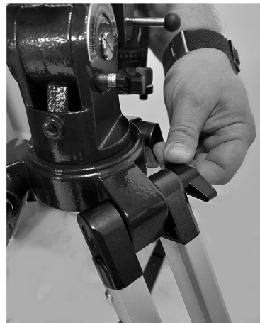
3. Установите экваториальную монтировку на штатив
