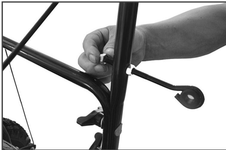
Рис. 13 Монтаж кронштейна рычага поворота желоба
