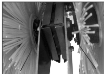
Рис. 4 Установка соединительных пластин крепления отвала
