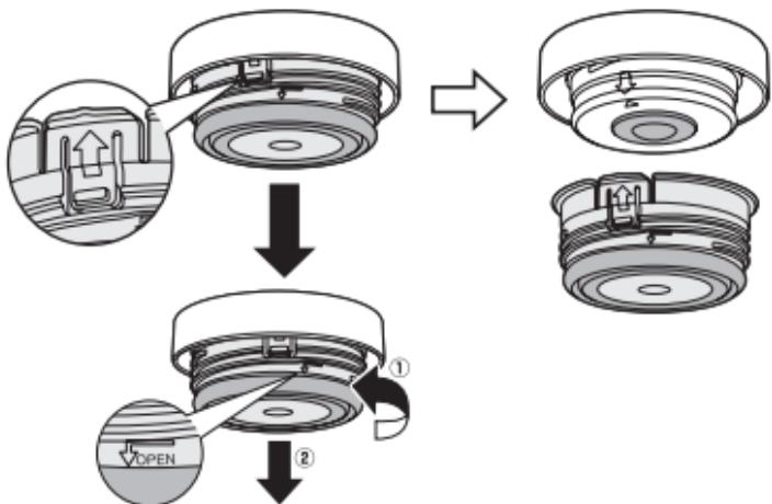
Чтобы разобрать крышку-пробку, поверните внутреннюю часть пробки в направлении указателя «OPEN» и потяните её вниз.
