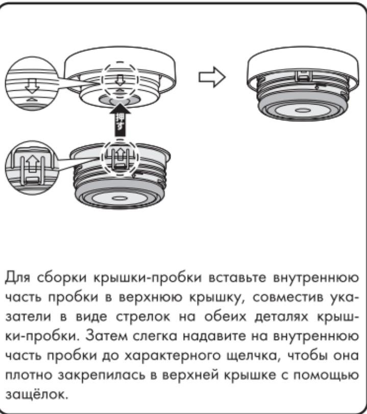
Для сборки крышки-пробки вставьте внутреннюю часть пробки в верхнюю крышку, совместив указатели в виде стрелок на обеих деталях крышки-пробки. Затем слегка надавите на внутреннюю часть пробки до характерного щелчка, чтобы она плотно закрепилась в верхней крышке с помощью защёлок.
