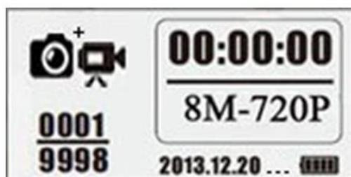
**Обратите внимание:** фотоловушка может работать в трёх режимах: видеосъемка, фотосъемка, а также съемка фото и видео. Вид экрана изменяется в зависимости от выбранного режима работы.
