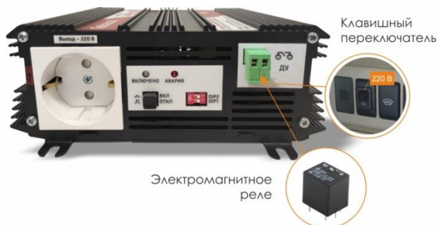
Рисунок 9 – Схема дистанционного включения инвертора
