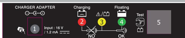
**1** 机适配器插孔，仅限使用随机提供的适配器
