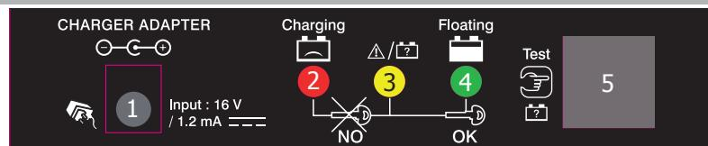
**1** Connessione per l'adattatore. Utilizzare soltanto il caricabatterie fornito con il prodotto.
