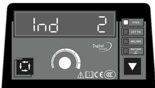
Рисунок 5. Установка индуктивности. Диапазон – 2 ~ 2
