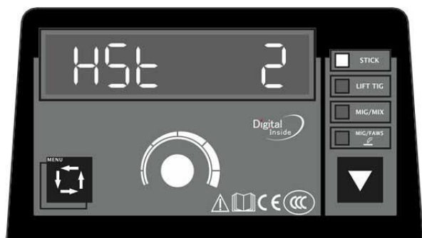
Рисунок 3. Установка времени горячего старта. Диапазон 0.2~2 сек.
