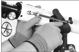
7. Вставьте штангу высоты в соответствующее посадочное отверстие вилки монтировки
