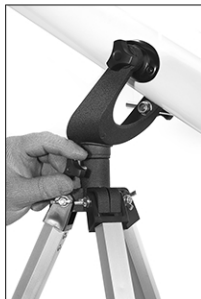
14. Для регулировки по азимуту ослабьте винт
