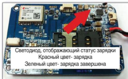
Во время работы устройства, светодиод, отвечающий за статус устройства, мигает в 8ми секундном цикле, отображая GSM и GPS статус в каждом цикле (есть небольшой интервал между ними).
