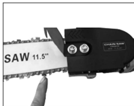
15. Убедитесь, что цепь установлена правильно: на нижней стороне шины режущий зуб должен быть направлен назад (на верхней стороне - вперед)
