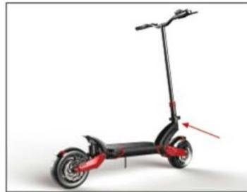
Ослабьте крепление хомута и сдвиньте его вверх по рулевому валу
