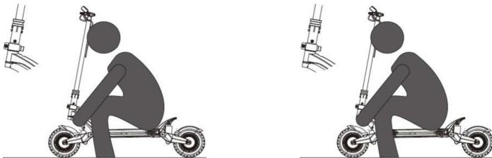
Если чувствуете рулевая стойка расшатана, то подтяните гайку в месте механизма складывания, как показано на иллюстрации.
