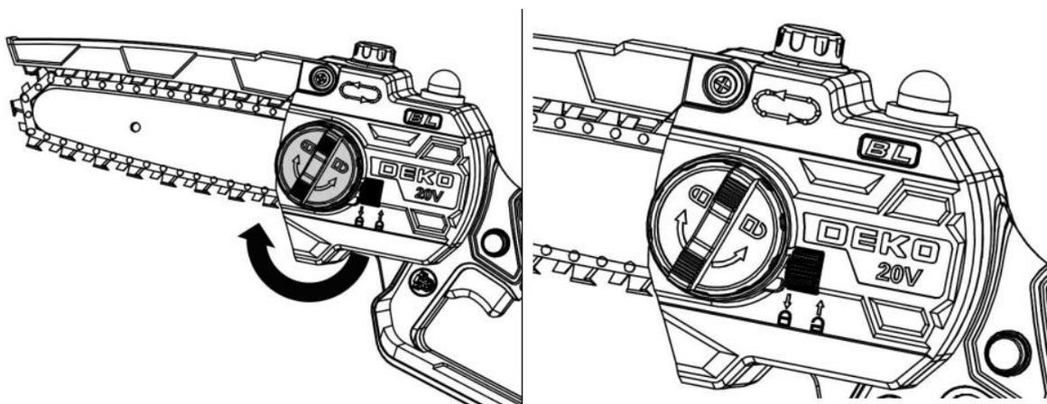
4. Затяните крышку, поворачивая барашек бесключевой фиксации шины по часовой стрелке.
