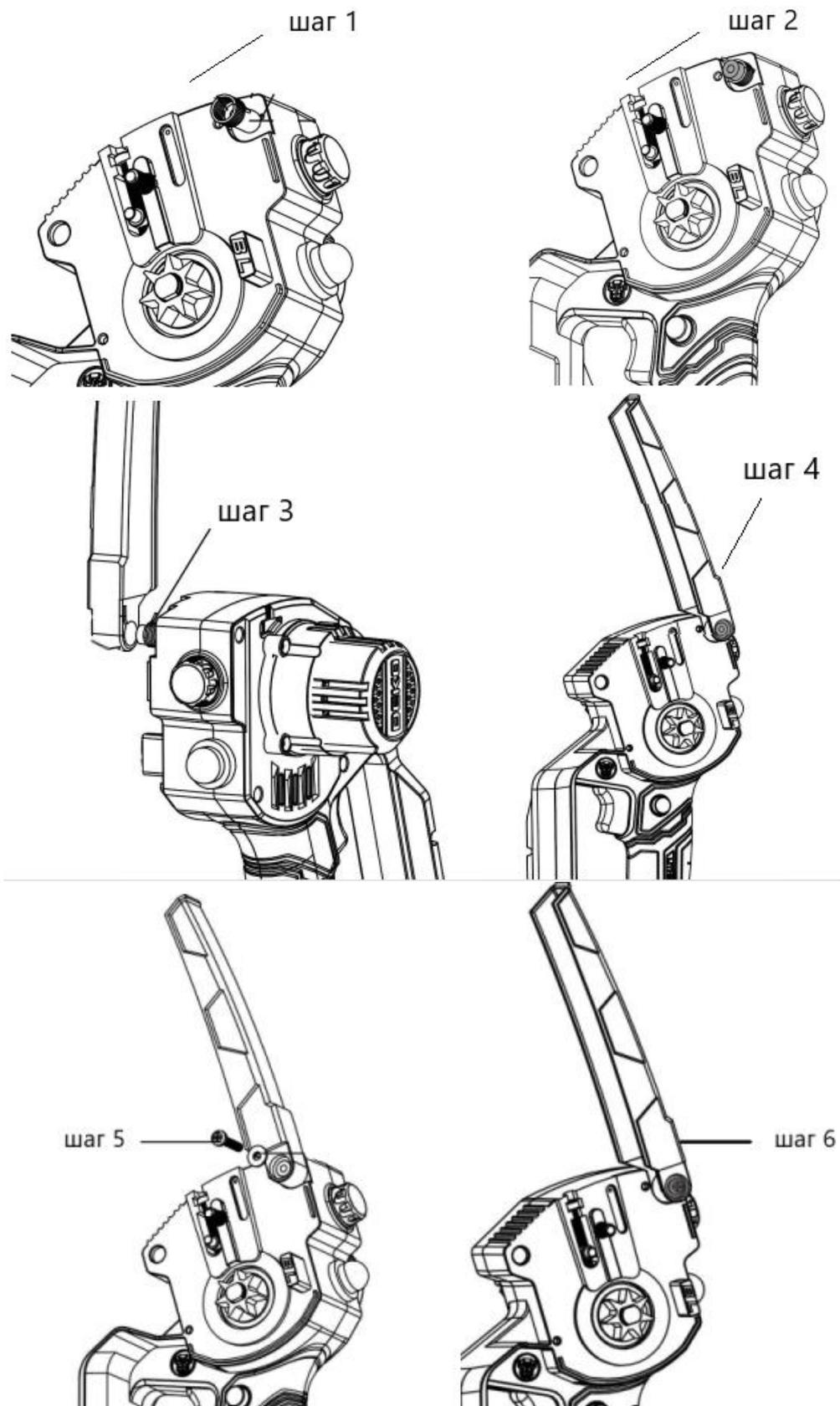
2. Для установки защитного кожуха следуйте порядку сборки на изображениях.
