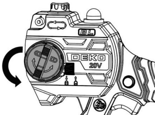
1. Крышка крепится барашком бесключевой фиксации шины. Для того, чтобы ослабить крепление шины и снять крышку, вращайте его против часовой стрелки, для фиксации – по часовой.
