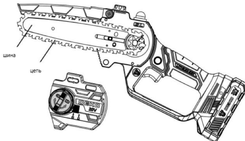
3. Установите шину и цепь, обращая внимание на направление режущих зубцов цепи. Они должны быть направлены в сторону движения цепи.
