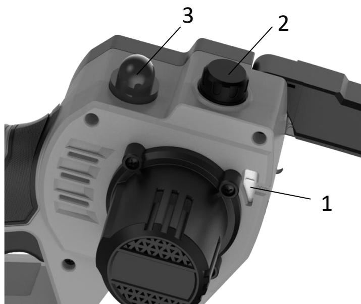
Модель оснащена масляным баком емкостью 22мл. Отслеживайте уровень масла с помощью индикаторного окошка (1). Когда уровень масла в баке достигнет пометки MIN, заполните масляный бак маслом для смазки цепных пил.
