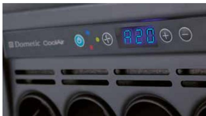
Управление климатом нажатием кнопки: понятная без пояснений панель управления салонного блока испарителя CoolAir SP 950I
