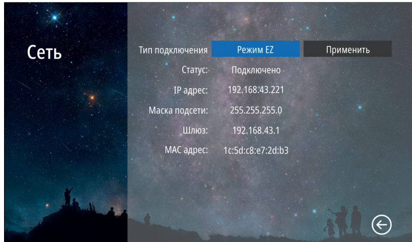
Рис. 38 Подменю "Сеть". Подключение в режиме EZ
