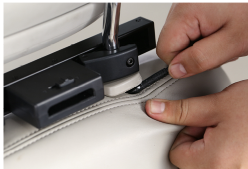
Протяните провод питания монитора под фиксатором подголовника
