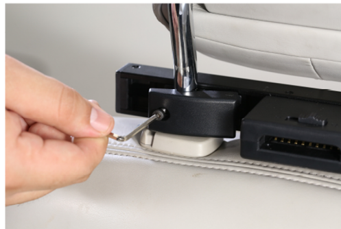
Зафиксируйте крепление шестигранным ключом, чтобы оно сидело плотно
