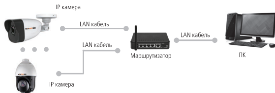
Рис. 6 Подключение IP камеры, вариант 2
