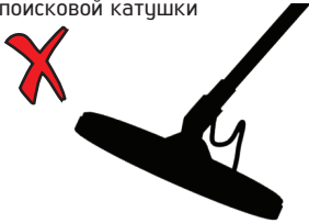
Неправильный угол наклона поисковой катушки
