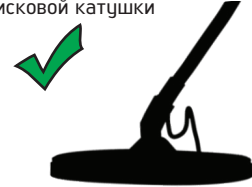
Правильный угол наклона поисковой катушки
