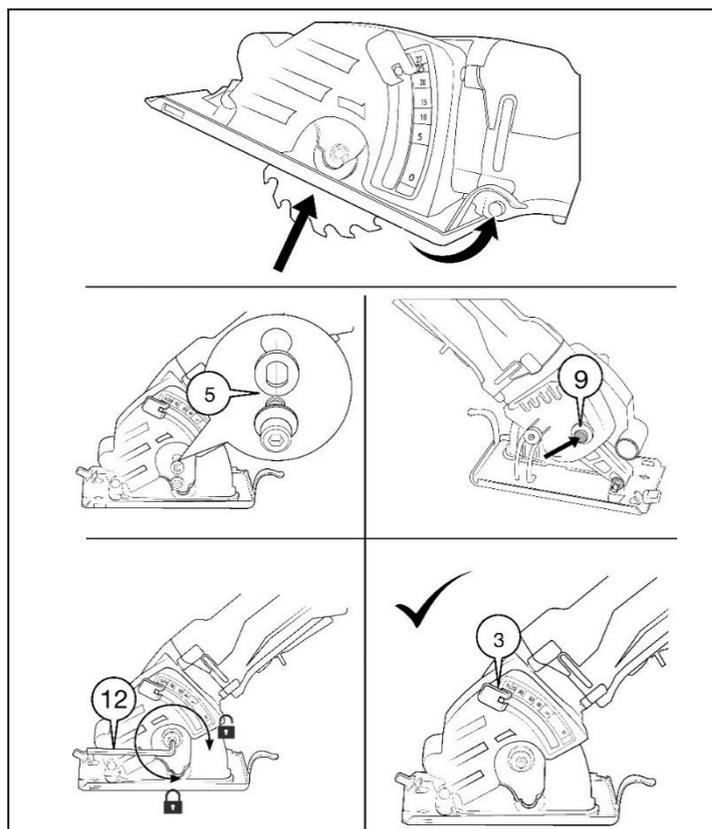
*Примечание: Осевой винт имеет левостороннюю резьбу. Для его фиксации необходимо поворачивать ключ против часовой стрелки.*
