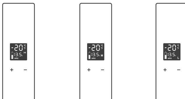
Когда устройство подключено к автомобилю, мы предлагаем установить защиту аккумулятора на уровень (H). (M) и (L) предлагаются, когда устройство подключено к резервной батарее. Разные автомобили могут иметь разное выходное напряжение. Если отображается защита по напряжению (дисплей F1 на светодиодном индикаторе), установите защиту аккумулятора с (H) на (M) или (L).
