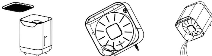
Поверните и снимите крышку фильтра, достаньте фильтр.
