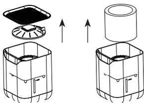
Для промывки фильтра можно его погрузить на 1 час в чистую воду, а потом аккуратно промыть слабой струей проточной воды. При необходимости следует заменить фильтр. После мойки или замены фильтра установите его в мойку воздуха, закройте поворотом крышку фильтра и крышку емкости для воды.
