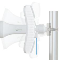
**7.** Ослабьте крепежную гайку шарового кронштейна и направьте антенну в сторону базовой станции того оператора, чья SIM-карта вставлена в антенну. Ориентируйтесь на индикацию уровня сигнала, расположенную на корпусе рупора. После определения наилучшего направления антенны → затяните крепежную гайку.
