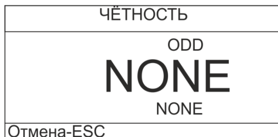
Рисунок 31 – Чётность интерфейса RS485
