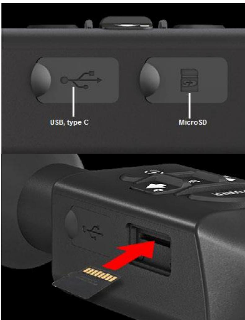
Устройство оснащено портами microSD и USB (тип C). Вы можете найти их под резиновыми колпачками на правой стороне устройства (крышки отмечены соответствующими значками).
