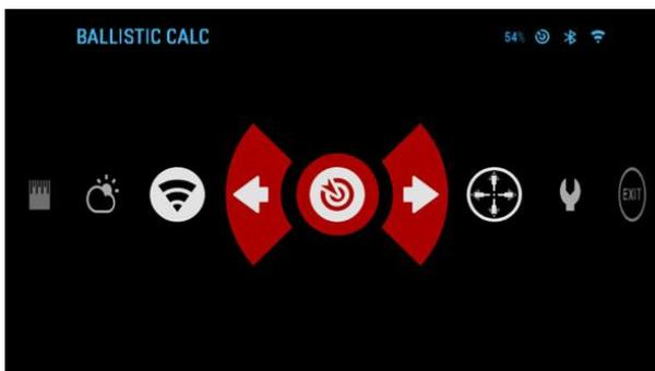
X-Sight 4K имеет интегрированный баллистический калькулятор, который позволяет Вашей прицеле корректировать точку попадания. Первый шаг в использовании этой функции требует, введения соответствующей баллистической информации в используемый профиль.
