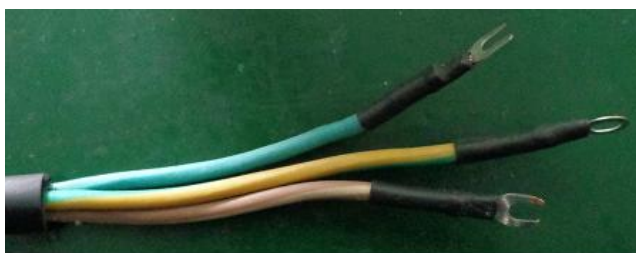
3 провода силового кабеля: коричневый, синий и желто-зеленый.
