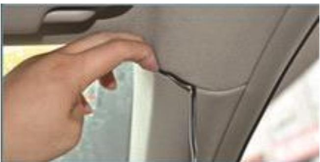
3. Спрячьте провод питания между швами внутренней обшивки автомобиля.
