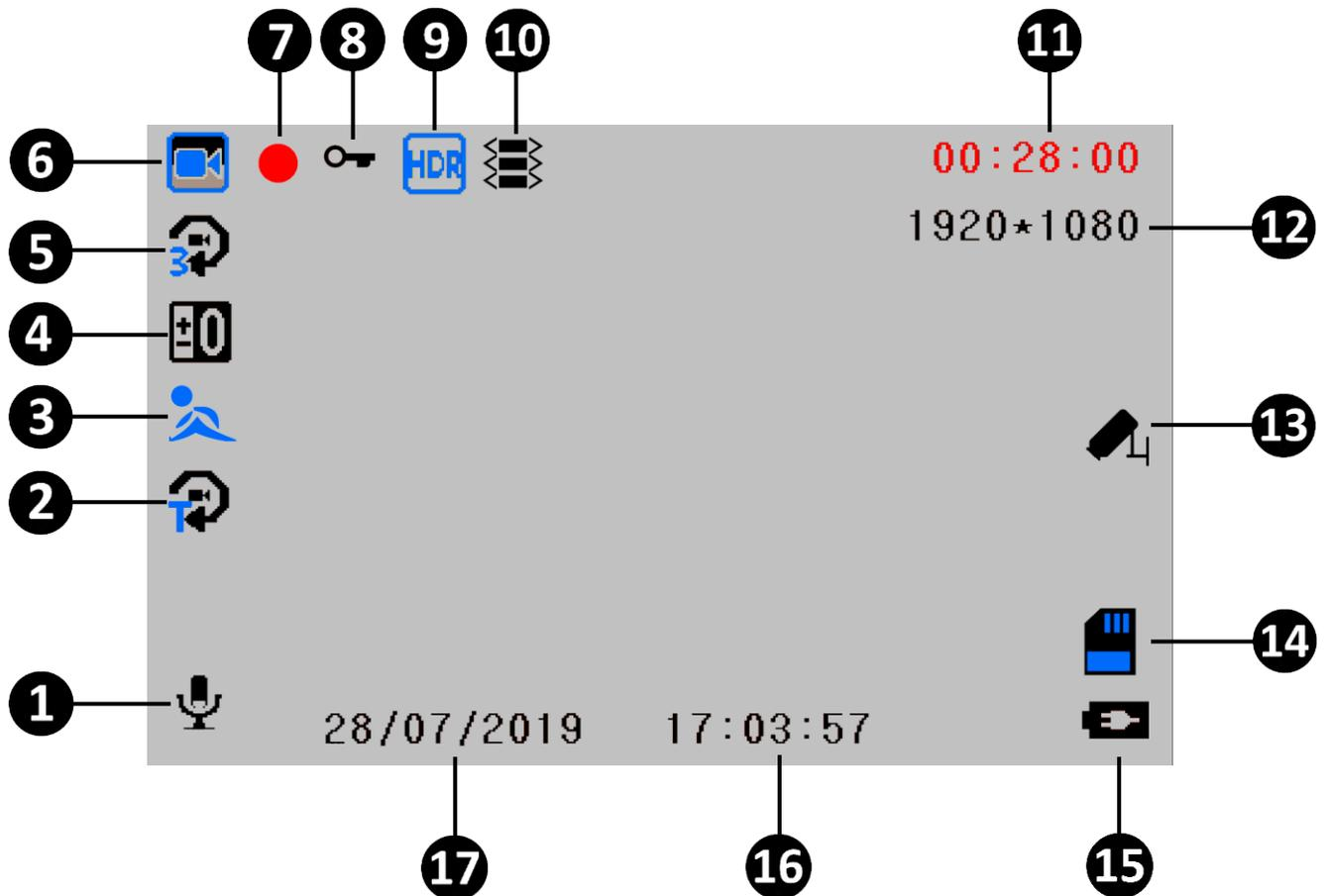
1. **Микрофон** - индикатор указывает на состояние микрофона (включен/выключен).
