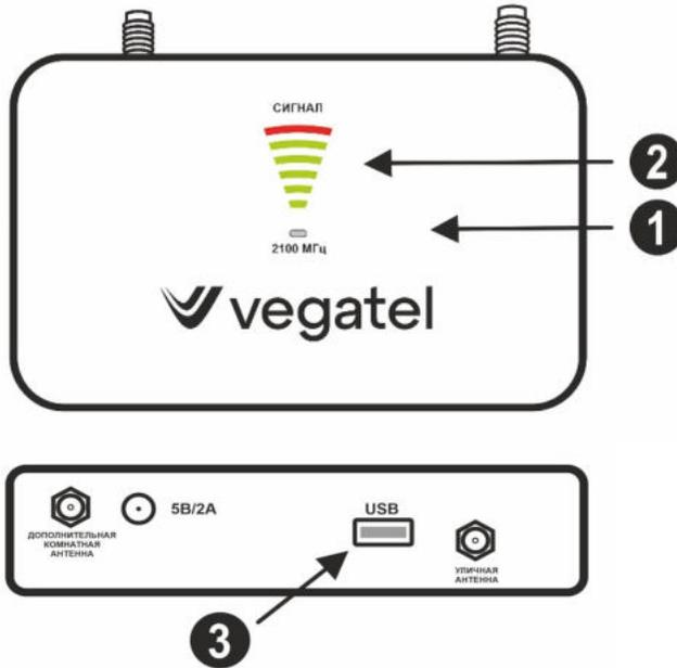
(1) Индикатор частотного диапазона — горит зеленым индикатор того диапазона, мощность которого в данный момент отображается на шкале «Сигнал» (см. 3.2).
