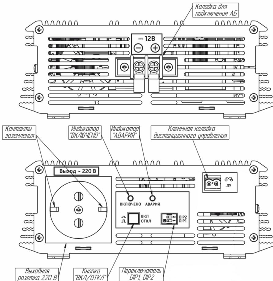
Рисунок 3 – Боковые панели инвертора СибВатт 312М/324М
