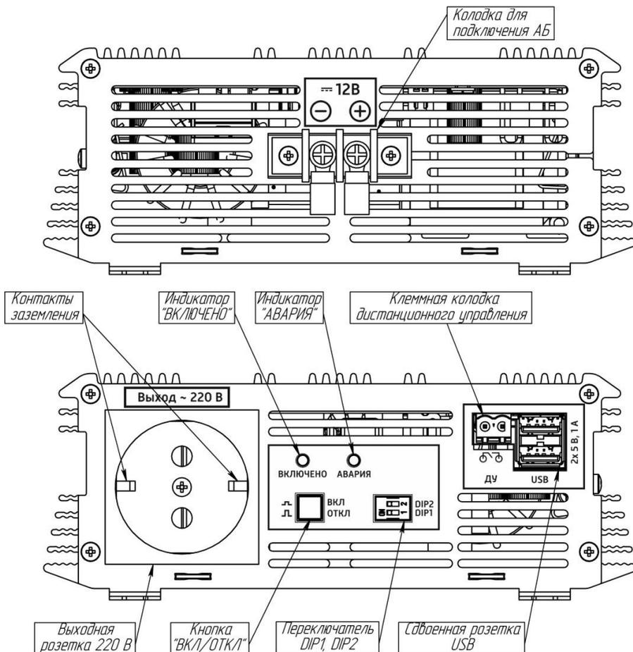
Рисунок 6 – Боковые панели инвертора СибВатт 312/324
