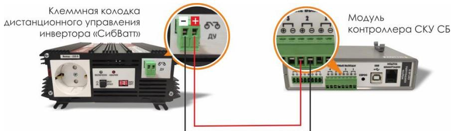
Рисунок 10 – Схема подключения к модулю контроллера СКУ АБ
