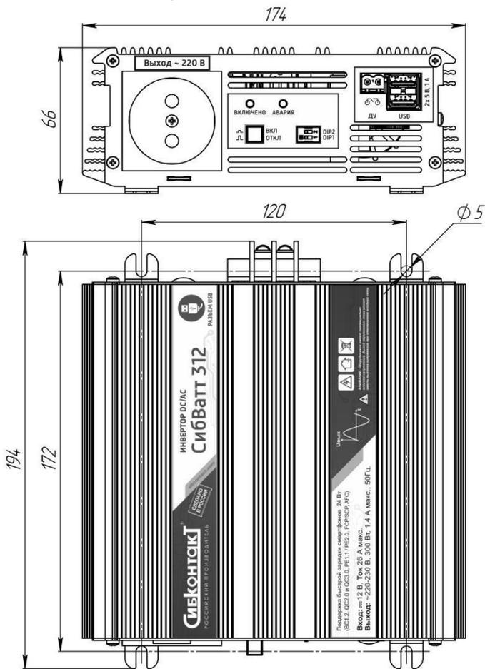
Рисунок 5 – Установочные и габаритные размеры СибВатт 312/324
