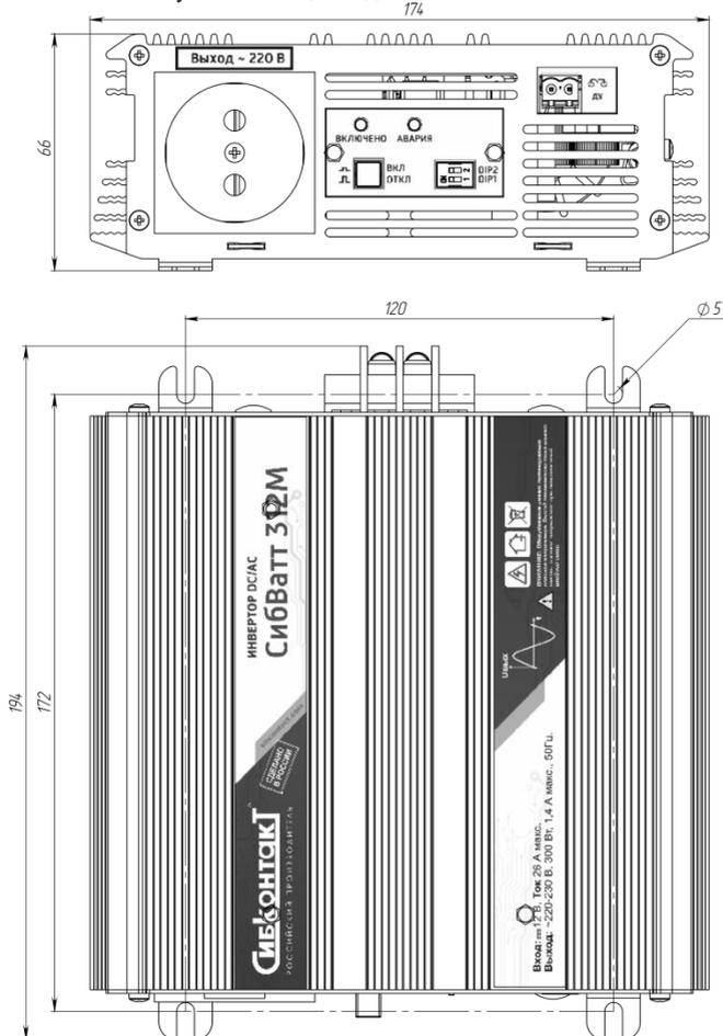
Рисунок 2 – Установочные и габаритные размеры СибВатт 312М/324М
