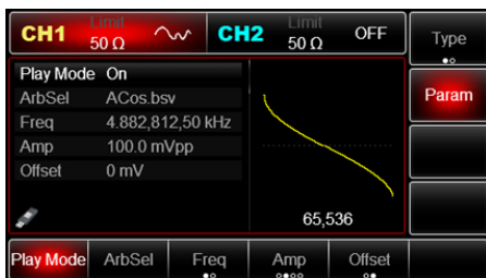
Рис. 120 Установка функции поточечного вывода
