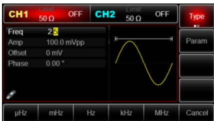
Рис. 7 Настройка частоты выходного сигнала
