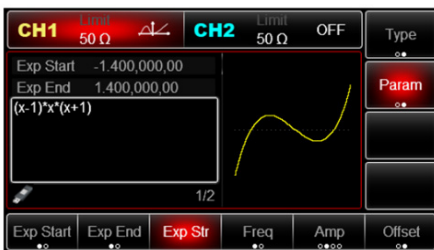
Рис. 17 Сигнал, заданный математической функцией
