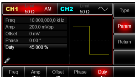
Рис. 25 Выбор параметров несущего сигнала
