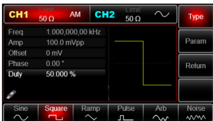
Рис. 24 Выбор формы несущего сигнала
