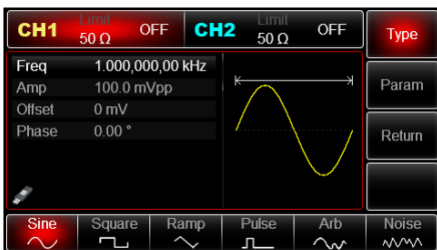
Рис. 39 Выбор формы несущего сигнала
