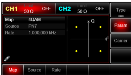
Рис. 84 Параметры квадратурной амплитудной модуляции
