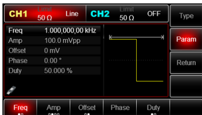
Рис. 101 Установить амплитуду сигнала
