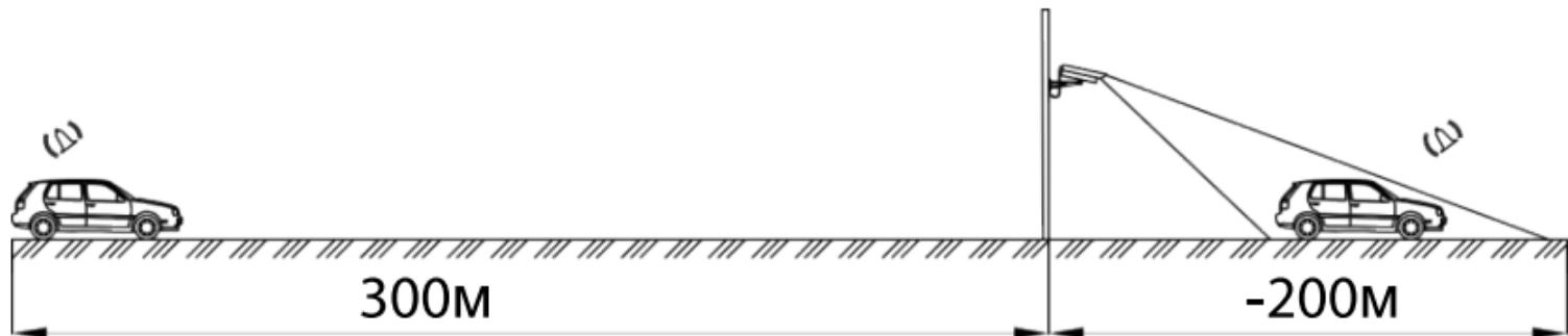
Оповещение о приближении к камере, работающей «в спину», начинается при превышении установленного вами в меню (см. п. VII «Структура меню комбо-устройства INTEGO BLASTER.» выше) порога скорости за 300 м до места установки камеры следующим образом: звучит голосовое оповещение о типе камеры и о том, что она работает «в спину». На дисплее выводится отсчет расстояния до точки установки камеры – от 300 до 0.
