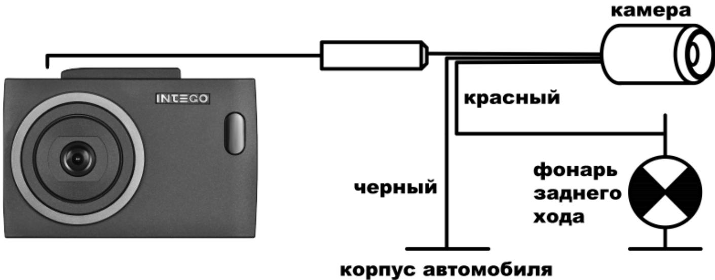
Если схема подключения реализована верно, при включении передачи заднего хода экран видеорегистратора автоматически переключится на изображение с камеры заднего вида. Камера заднего вида INTEGO AP-030 постоянно транслирует парковочную сетку, что может облегчить ваши маневры при парковке автомобиля.
