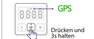
Warnung: Die Anzeigelampe kann nicht dauerhaft grün bleiben. Bitte überprüfen Sie die Stromversorgung oder versuchen Sie es nach dem Ändern des Installationsorts erneut.
