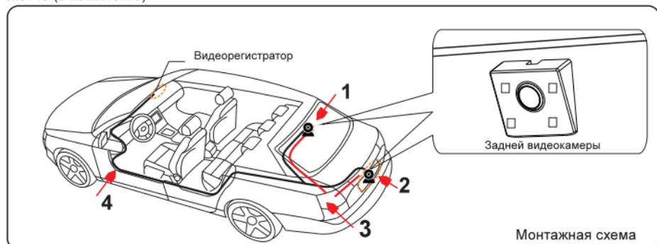
**Вариант установки 1.** Внутри салона на 3М скотче. Установка на внутренней части стекла подходит для автомобилей повышенной проходимости (SUV) или хэтчбэков.
