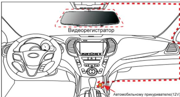
Расположение зеркала заднего вида в автомобиле
