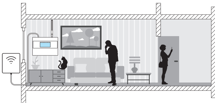
Рис. 10 Неправильное расположение элементов системы в квартире
