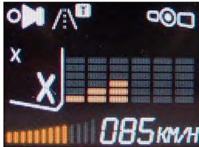
При обнаружении радарного сигнала во время оповещения по базе данных системы **GPS**, сообщение о сигнале выводится в левом нижнем углу дисплея детектора одновременно с информацией от базы данных.
