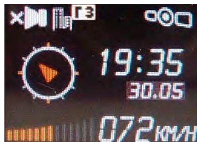
На рисунке: Движение на северо-восток со скоростью 77 км/час, в супер тихом режиме приёма, местное время 19 часов 36 минут, звук снова включен:
