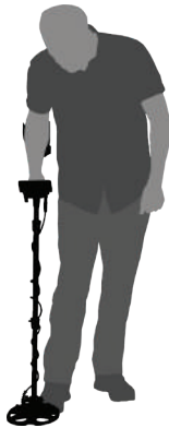
Высота штанги отрегулирована неверно
