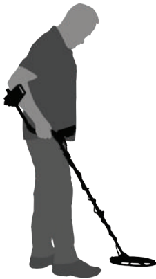
Высота штанги отрегулирована неверно
