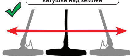
Правильный проход катушки над землёй
