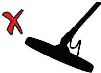
Неверный угол поисковой катушки к земле
