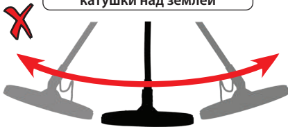
Неправильный проход катушки над землёй
