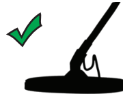
Правильный угол поисковой катушки к земле
