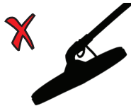
Неверный угол поисковой катушки к земле
