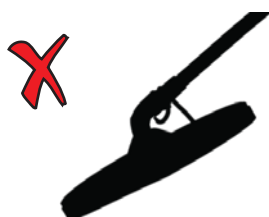
Неверный угол поисковой катушки к земле
