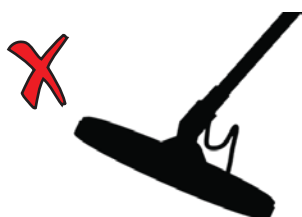
Неверный угол поисковой катушки к земле
