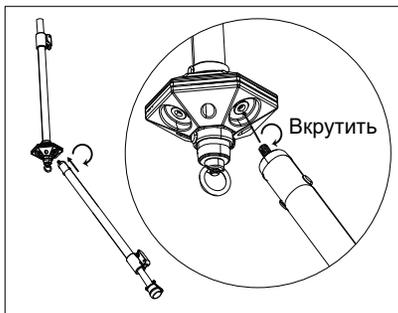
Сначала соберите стойку и ножки штатива. Пожалуйста, для безопасности затяните хорошо все соединения.
