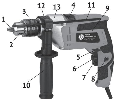
1 - кулачки патрона; 2 - втулка патрона; 3 - обойма патрона; 4 - переключатель режимов (сверление/ сверление с ударом); 5 - переключатель направления вращения - реверс; 6 - диск регулятора оборотов; 7 - клавиша выключателя; 8 - кнопка фиксации клавиши в рабочем положении; 9 - корпус; 10 - рукоятка дополнительная; 11 - стержень-ограничитель глубины сверления; 12 - хомут крепления рукоятки и стержня; 13 - корпус редуктора.
