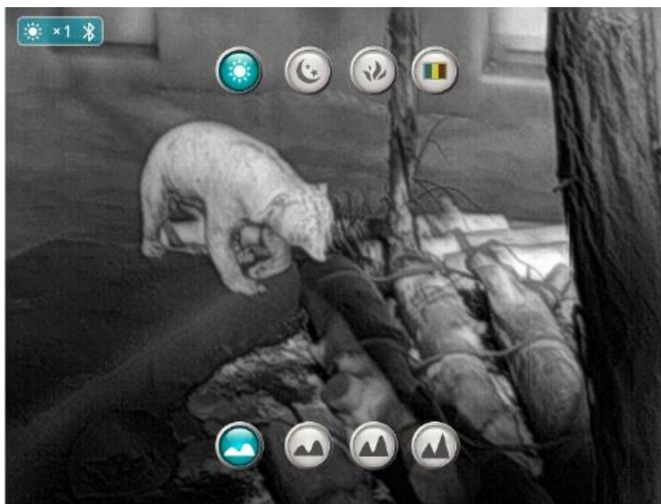
Рис, 4, Меню настройки после 1-го нажатия кнопки М ,
