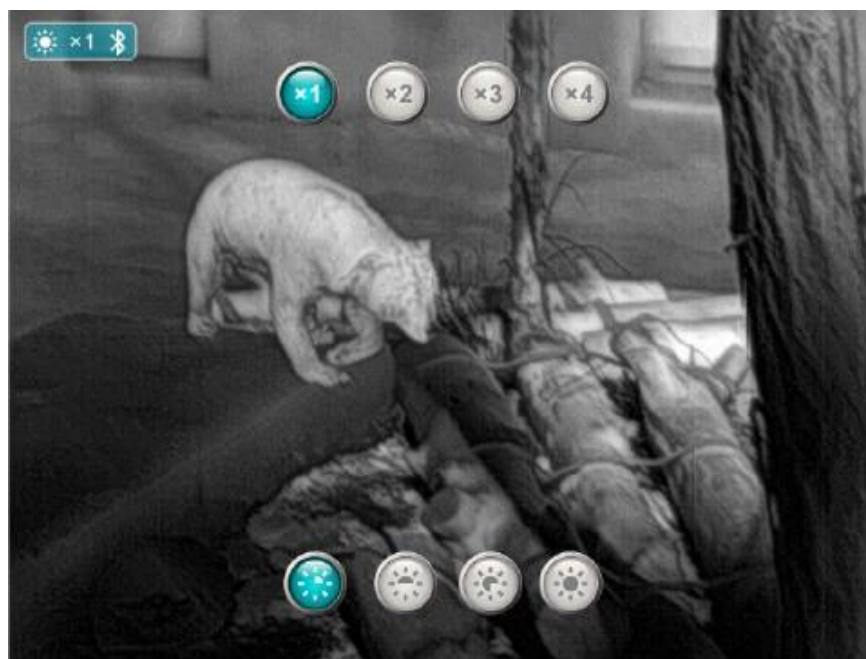
Рис, 5, Меню настройки после 2-го нажатия кнопки М.
