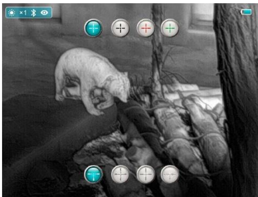
Рис. б. Меню настройки после 3-го нажатия кнопки М .
