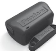
**GPS/ГЛОНАСС-приёмник NAV-035BT** – периферийное устройство, позволяет системе определять текущее местоположение, автоматически синхронизировать дату и время по UTS.
