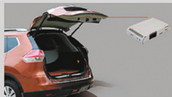
управляющий блок электроприводов двери багажника
