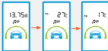
*\*Контроль температуры двигателя возможен только при подключенном к комплексу StarLine датчике температуры двигателя.*
