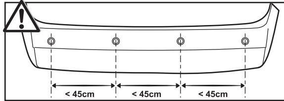
**!** Оптимальная высота установки датчиков - 50см от поверхности земли.
