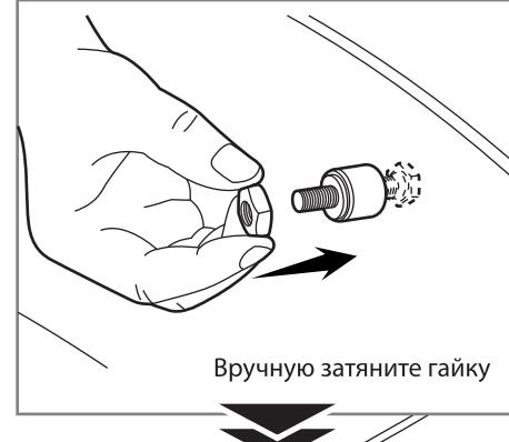
Вручную затяните гайку
