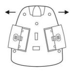
Установите батареи 9 В (Крона) в батарейный отсек, соблюдая символы полярности (+ и -), отмеченные внутри, и установите на место левую и правую крышки батарейного отсека.
