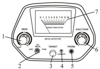
SENS - контроль чувствительности, а также используется в качестве выключателя питания.
