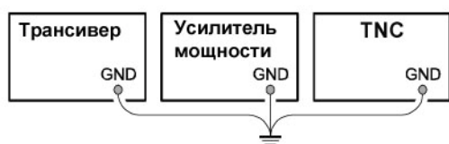
Правильное подключение заземления
