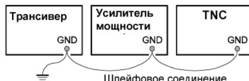
Неправильное подключение заземления
