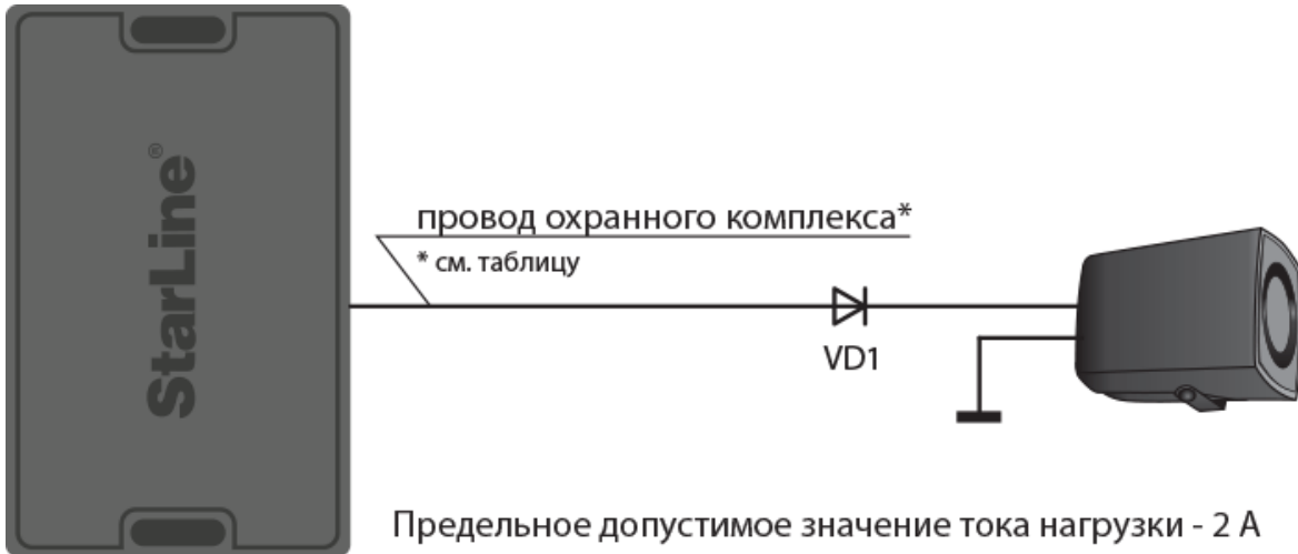
Схема подключения автомобильной сирены
