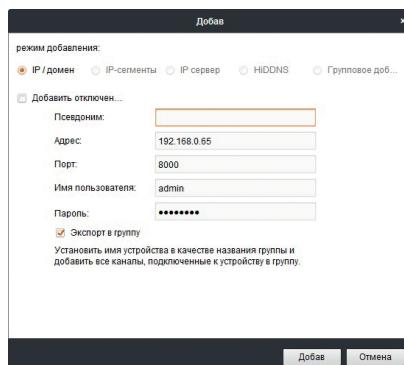
Рис. 43 Добавление устройства
