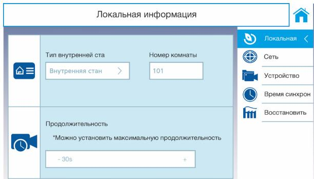
Рис. 9 Ввод номера квартиры
