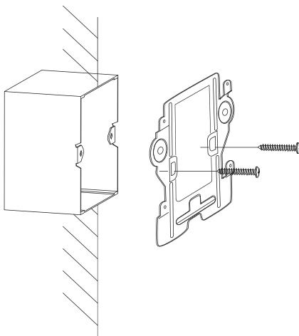
Рис. 5 Установка монтажного кронштейна на коробку
