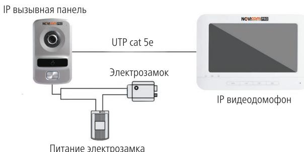
Рис. 7 Схема подключения замка к вызывной панели
