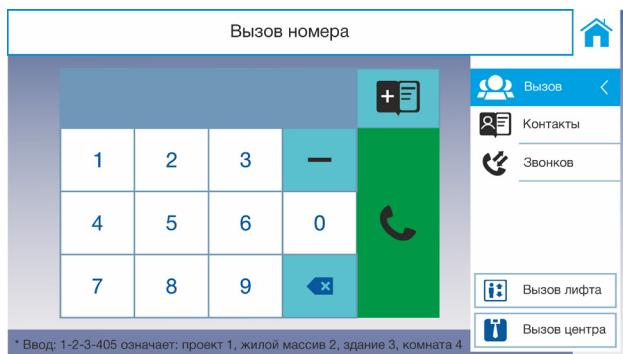
Рис. 24 Раздел «Интерком» видеодомофона NDM7F
