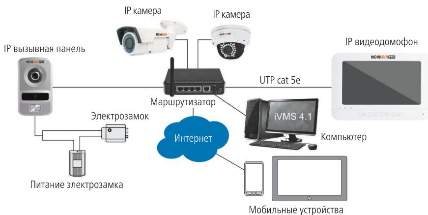
Рис. 8 Пример схемы подключения NDM7F
