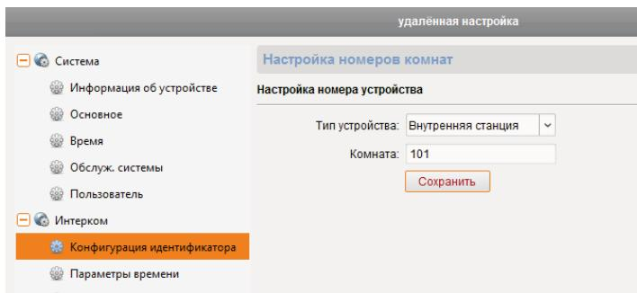
Рис. 10 Удаленный ввод номера квартиры
