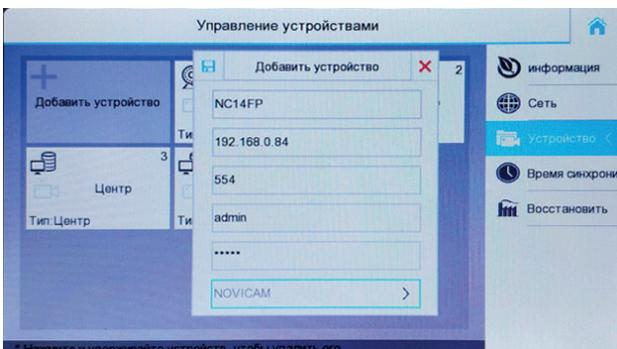
Рис. 14 Добавление IP камеры
