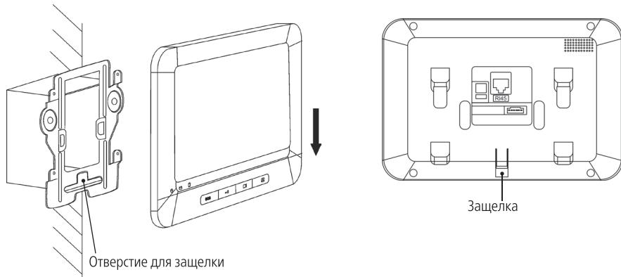
Рис. 6 Установка монитора
