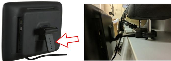
4. Зафиксируйте устройство в креплении фиксатором.
